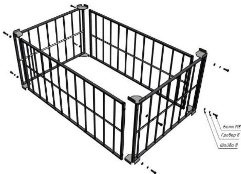
Рис. 1 Схема сборки ограждения ОПК-500
